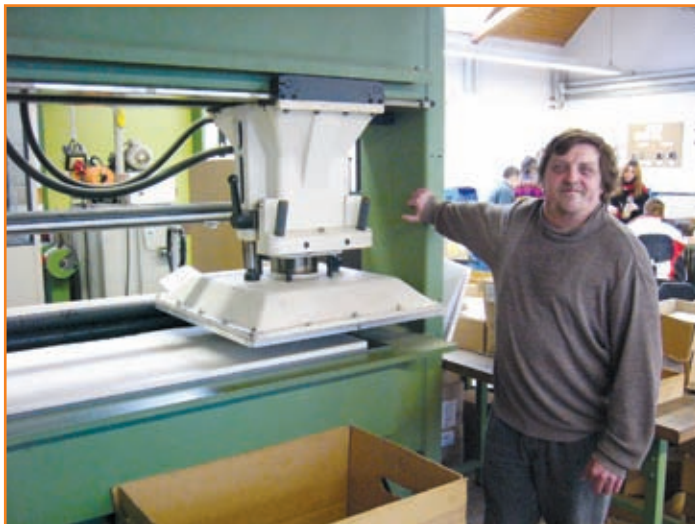
Stanze zum Herstellen von Kälteisolierungen in der Lebenshilfe Bruchsal
